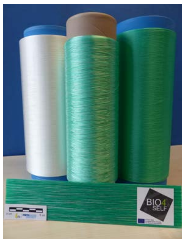
Eigenverstärkter Faserverbundkunststoff (eFVK) aus PLA und PLA-Fasern
