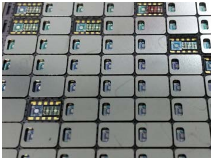
Batch aus Sensor-Präkonzentrator-Systemen, zum Teil abgedeckt mit exakt positioniertem Gaszutritt
