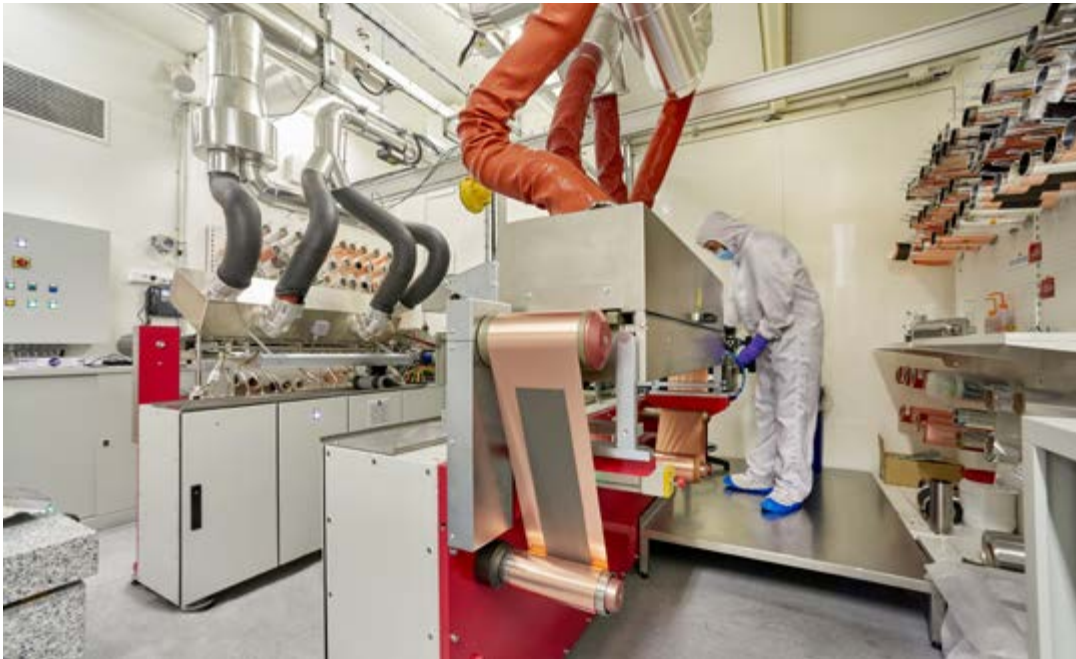
Beschichtungsmaschine des Projekts SINTBAT
