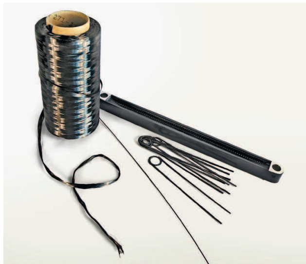
Aus Carbonfasern wird ein Kunststoffstrang mit Endlosfaserverstärkung, der sich mit dem neuen additiven Verfahren zu Preformlingen freier Geometrie verarbeiten lässt. Die Einleger werden als lokale Versteifungs- und Verstärkungselemente in die Bauteile integriert. Foto: Engel
