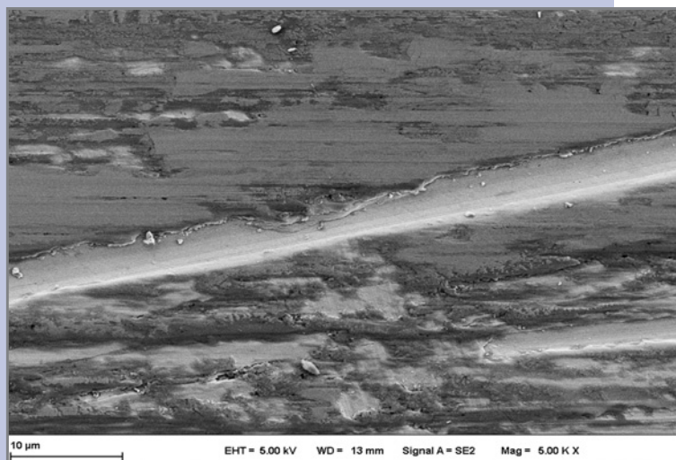
Stahlgegenkörper mit verschleißreduzierendem Tribofilm nach Kontakt mit LCP-Composite
