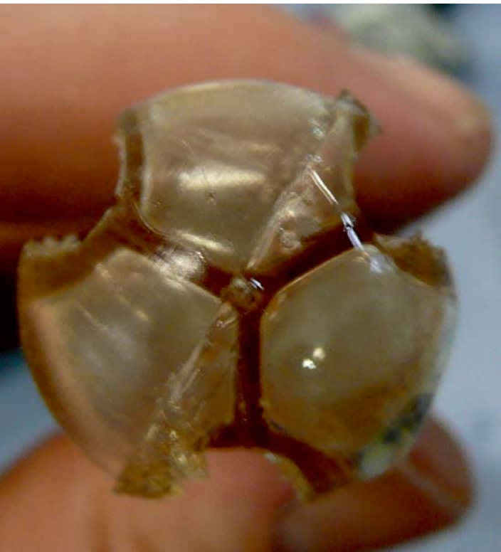
Abb. 1 Schlauchblase für homogene Verteilung von CNT Inflatable bladder for homogeneous CNT distribution
