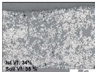
Abb. 3 Lichtmikroskopaufnahmen von Siphon-impregnierten Rovings Micrographs of rovings impregnated with the siphon impregnation unit
