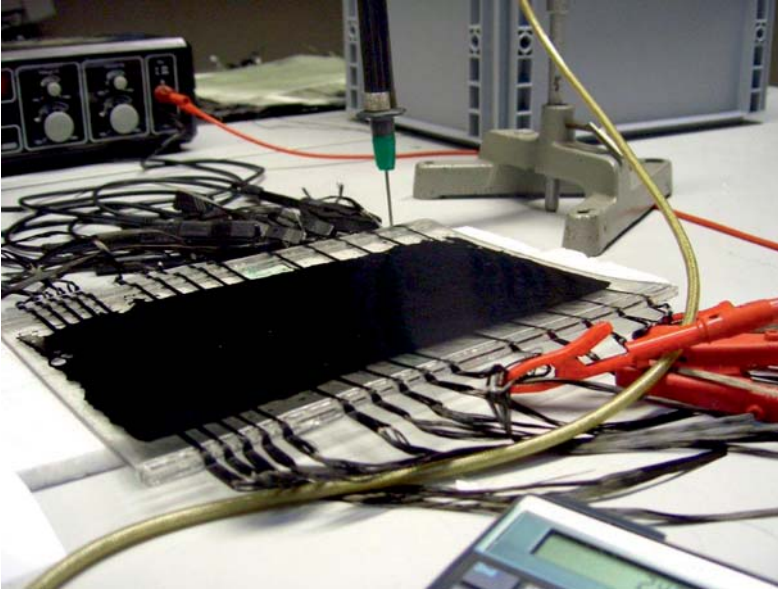
Abb. 1 Versuchsaufbau zur Messung der Temperatur bei Anlegen einer Spannung an die Heizfaserkomponente Experimental setup for the measurement of the temperature change after the application of a voltage to the fibrous heating component
