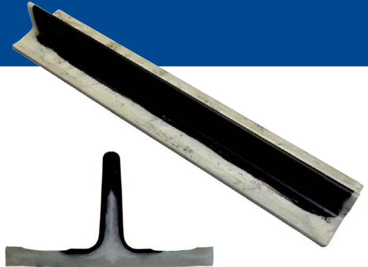
Abb. 2 Testprofil auf der Basis von langfaserverstärktem (hell) und endlosfaserverstärktem (dunkel) Thermoplast Manufactured T-section consisting of long fibre reinforced (light colored) and endless fibre reinforced (dark colored) thermoplastic
